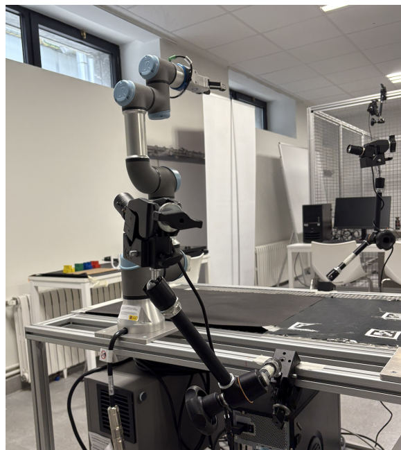
Figura B.5: Entorno experimental con el robot UR3e, dos cámaras, una facial y una de movimiento al fondo.
