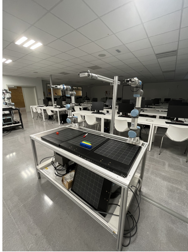
Figura 2.2: Robot colaborativo UR3e de Universal Robots en entorno de laboratorio
