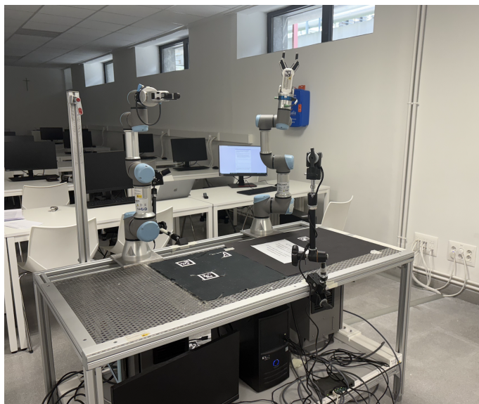
Figura B.2: Vista general del entorno experimental, mostrando el robot UR3e y dos cámaras empleadas para la captura de expresiones faciales.
