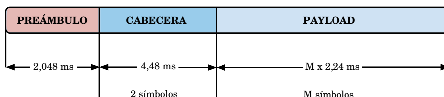
Figura A.1: Estructura de la trama PHY
