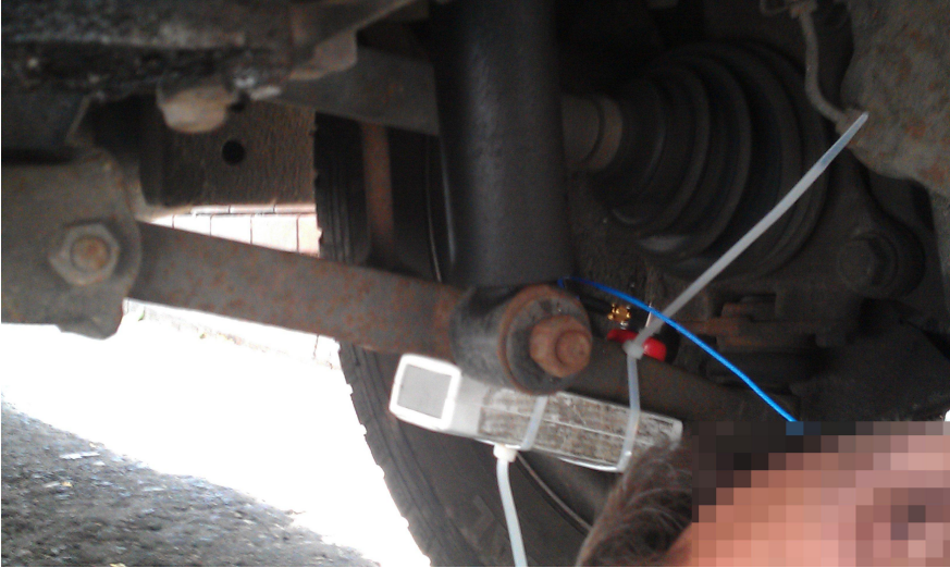
Figura 5.47: Sensor acelerómetro fijado al brazo inferior de la suspensión frontal izquierda de una furgoneta Volkswagen Transporter.
