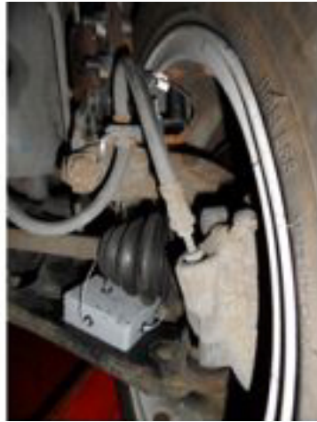
Figura 5.27: Sensor acelerómetro fijado al brazo de la suspensión delantera de un coche Ford Fiesta.
