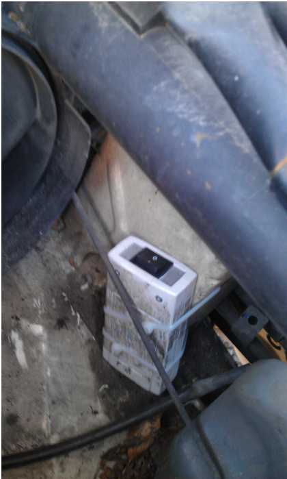
Figura 5.17: Sensor acelerómetro fijado al chasis cerca del filtro de aire de una furgoneta Volkswagen Transporter.
