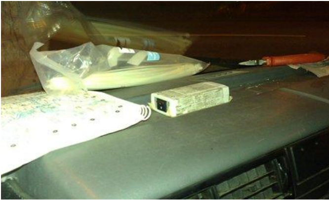
Figura 5.2: Sensor acelerómetro fijado al salpicadero de una furgoneta Volkswagen Transporter.
