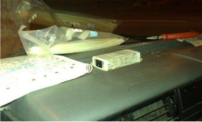
Figura 5.37: Sensor acelerómetro fijado al salpicadero de la furgoneta Volkswagen Transporter.
