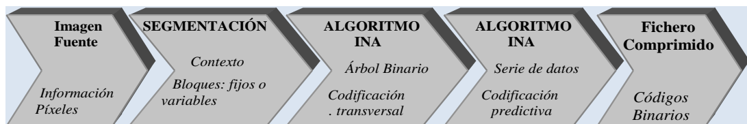
Figura 4.12. Diagrama de bloques simplificado del ciclo de compresión
