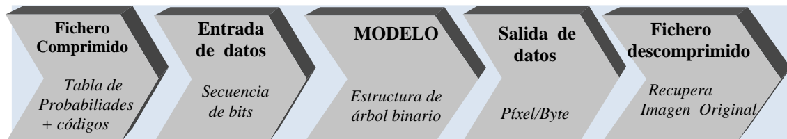
Figura 3.14. Estructura del ciclo de descompresión
