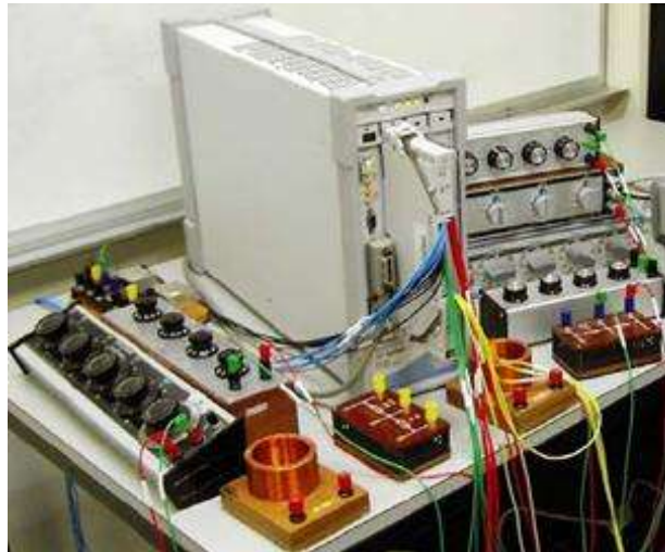
Figura 2.12: Configuración de la matriz de conmutación NetLab
