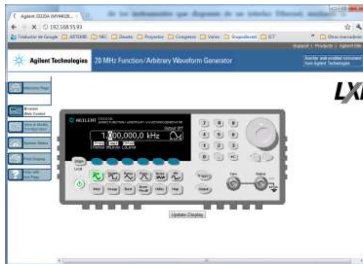
Figura 2.5: Interfaz web de un generador de funciones LXI
