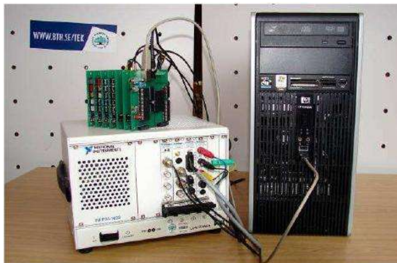
Figura 2.26: Instrumentos y servidor de equipos de la plataforma VISIR.
