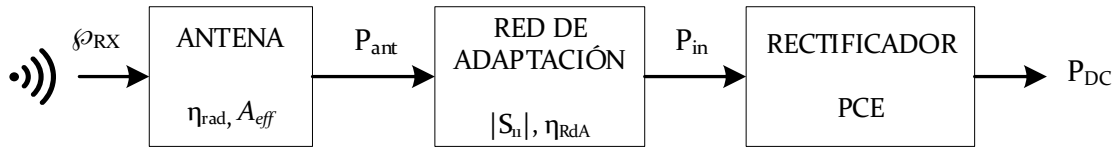
Figura 3-1: Diagrama de bloques de una rectenna básica.
