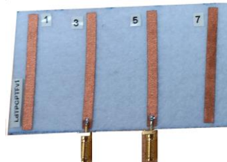
Figura 3-14: Implementación de la línea de transmisión de longitud \lambda/2 en PCPTF/Fieltro.
