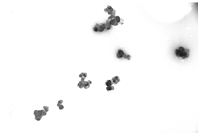
Figura 2.7: Agregados de carbon black capturados con un microscopio TEM.
