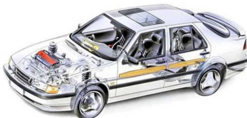
Figura 15: Primer uso de la estampación en caliente en un automóvil de serie. SAAB 9000. Viga de impacto lateral [SHFGTD21].
