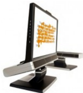
Ilustración 2.7: Sistema eye-tracking TobiiTX300. Fuente: http://www.tobii.com/
