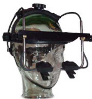
Ilustración 2.4: Sistema eye-tracking sobre la cabeza. Fuente: www.sr-research.com
