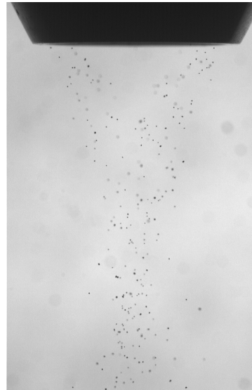
(d) Back illumination result: 4490 fps, 3× gain, 16 \mu s exposure
