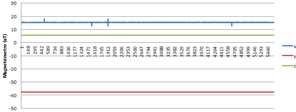
Figura 6.3: Señal obtenida por el magnetómetro en reposo
