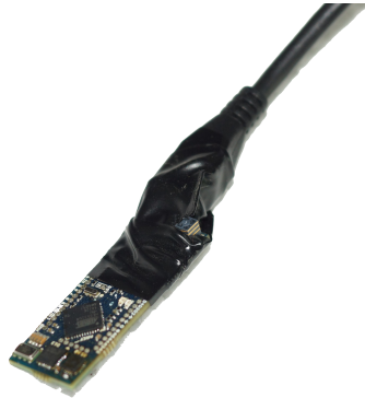
Figura 4.1: Sensor inercial desarrollado
