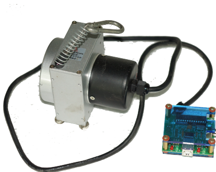
Figura 4.4: Encoder lineal con mosquetón de sujeción
