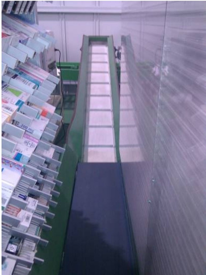
Figura 4.13. Cintas transportadoras horizontal e inclinada para la recogida de los productos desde los microservidores de dispensación hasta el punto de entrega en la caja.
