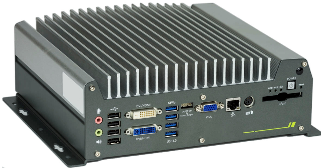
Figura 2.8. Los PC industriales destacan por su robustez frente a los computadores convencionales.
