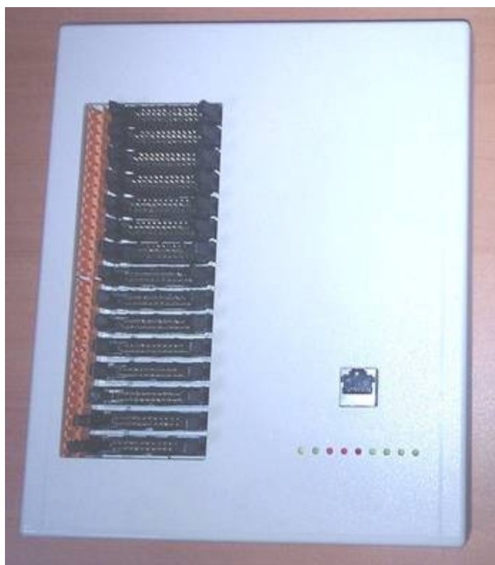
Figura 4.5. Switch de comunicaciones y alimentación para 250 microservidores de dispensación. La sustitución de una electrónica por otra, es tan sencillo como desconectar en orden los cables y conectarlos en un equipo nuevo.
