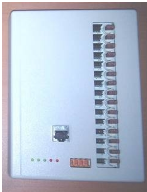
Figura 4.12. Switch con alimentación para los microservidores de reposición, con capacidad de manejo de hasta 90 microservidores de reposición.
