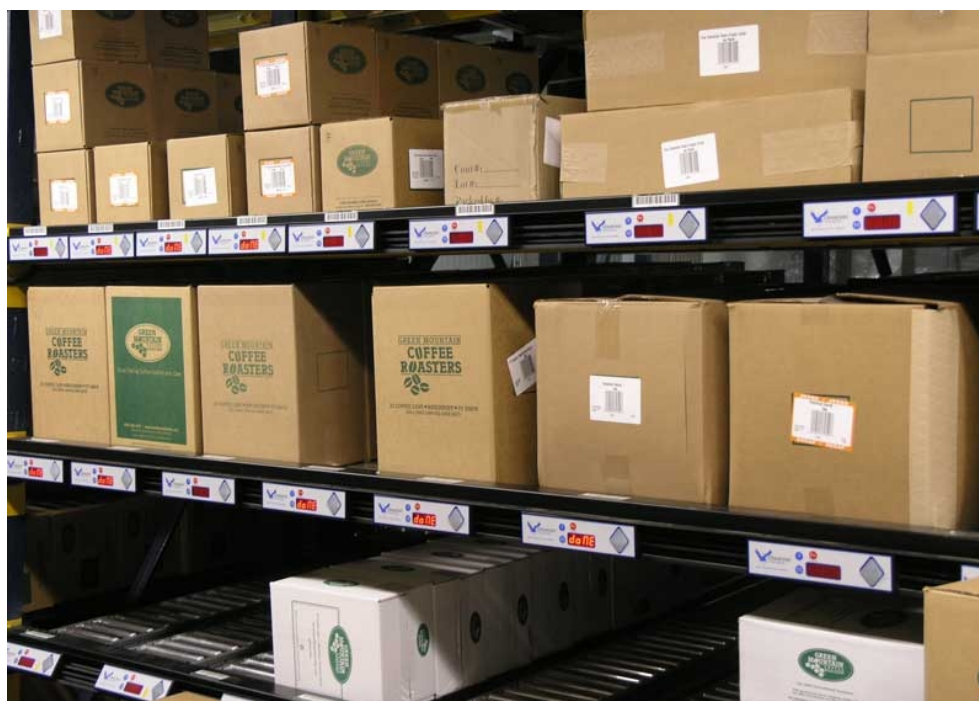
Figura 2.19. Soluciones tecnológicas pick-to-light y put-to-light del estado del arte actual para localización de productos en un almacén.
