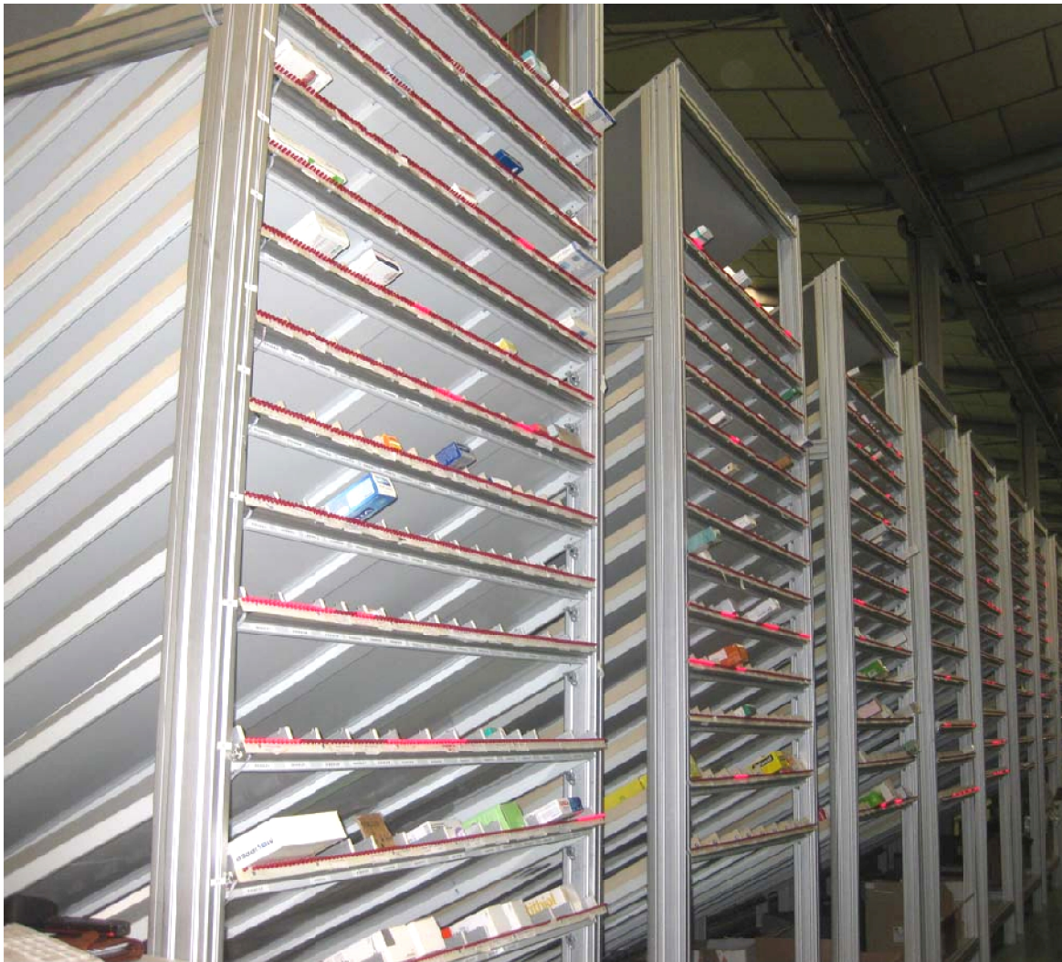
Figura 4.7. Los leds iluminados de forma fija por los microservidores de reposición indican que el carril correspondiente está vacío de producto y requiere reposición.
