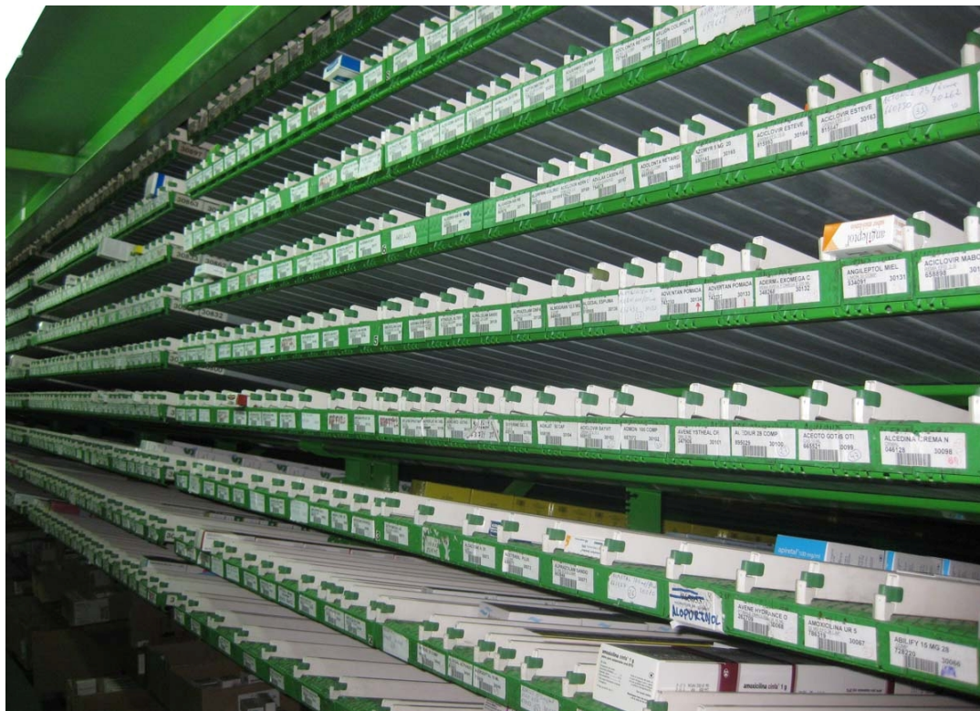
Figura 1.8. Vista del área de reposición de medicamentos en sistema de dispensación automática del fabricante SSI-SCHÄFER, conforme el escenario actual en almacenes de distribución farmacéutica.
