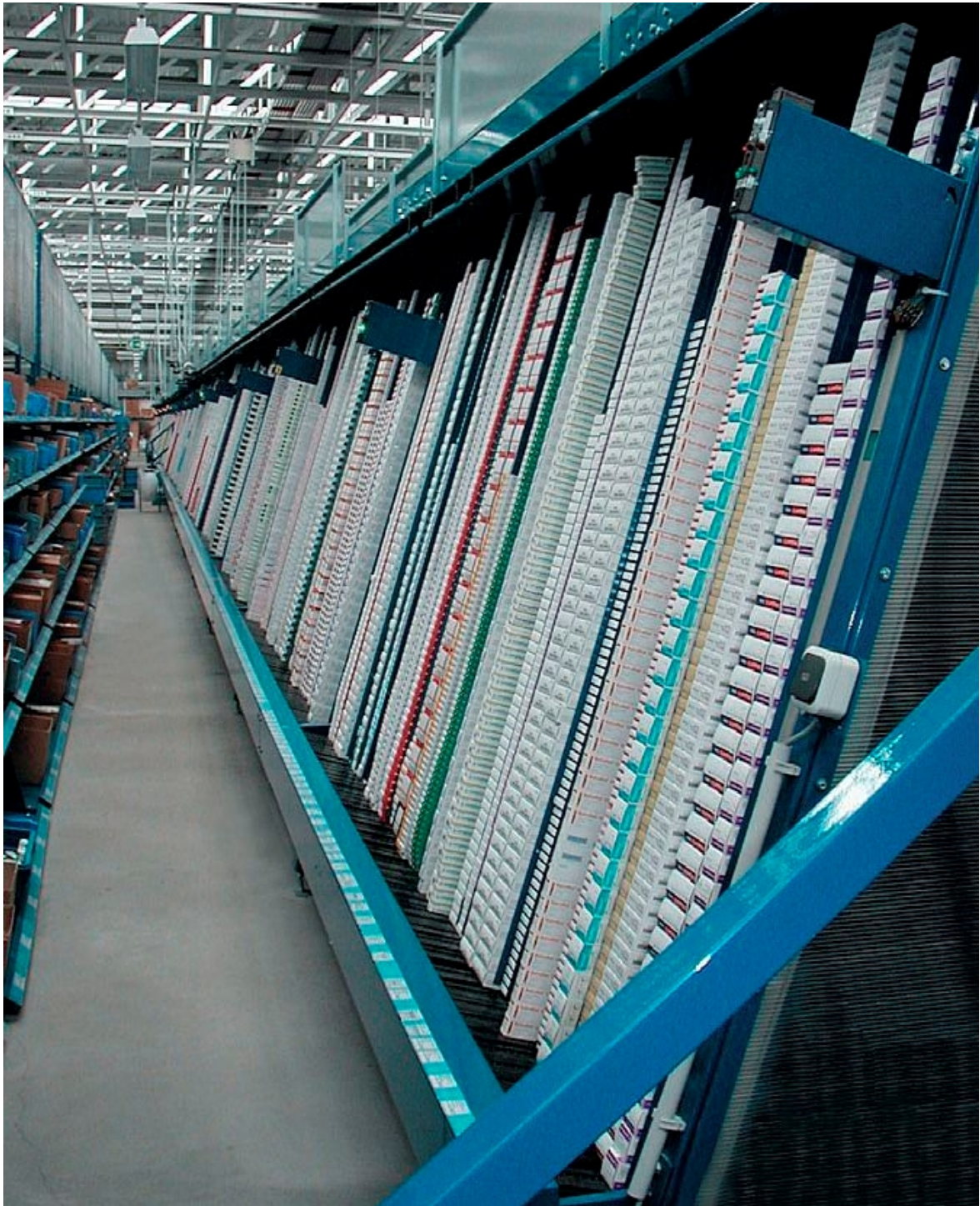
Figura 2.14. Los dispensadores de columna vertical ocupan un gran espacio en el almacén en relación producto automatizado / superficie requerida.
