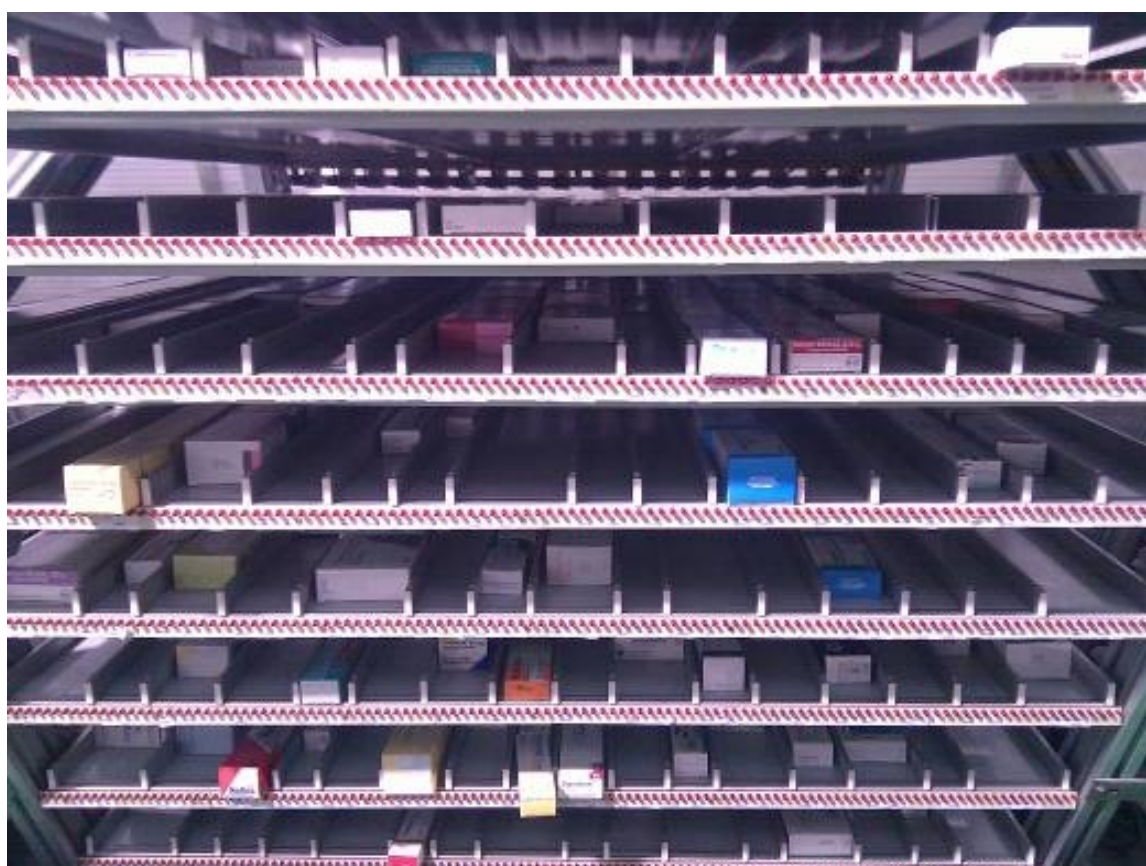
Figura 4.6. Microservidores de reposición con leds equipados en la parte trasera de las baldas para reposicionamiento semiautomático e indicación de carriles vacíos.
