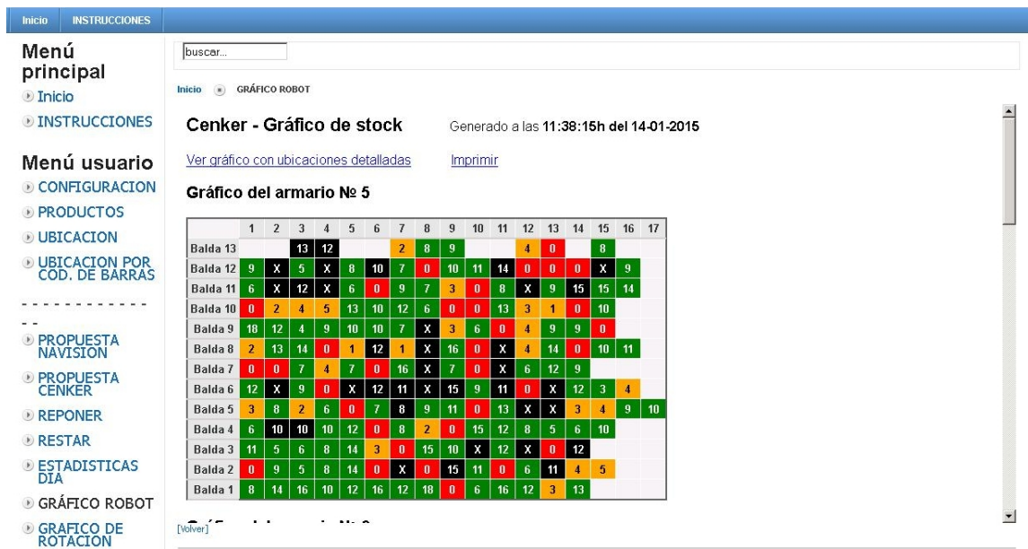
Figura 4.28. La visualización gráfica de los carriles de los módulos de dispensación mediante colores y con datos simplificados o ampliados facilita el trabajo de reconfiguración y ajuste de las máquinas.
