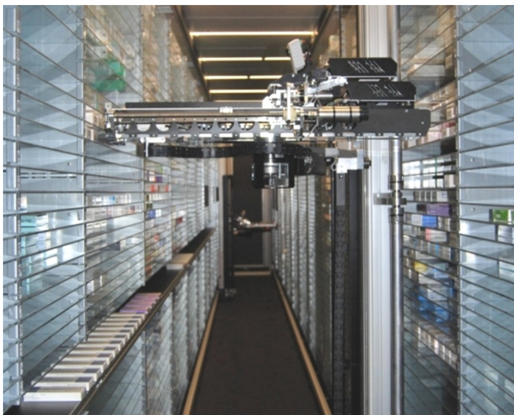
Figura 2.16. Dispensador basado en manipulador con ejes cartesianos. Al realizar las tareas una a una, es adecuado para farmacias, no para almacenes de distribución.
