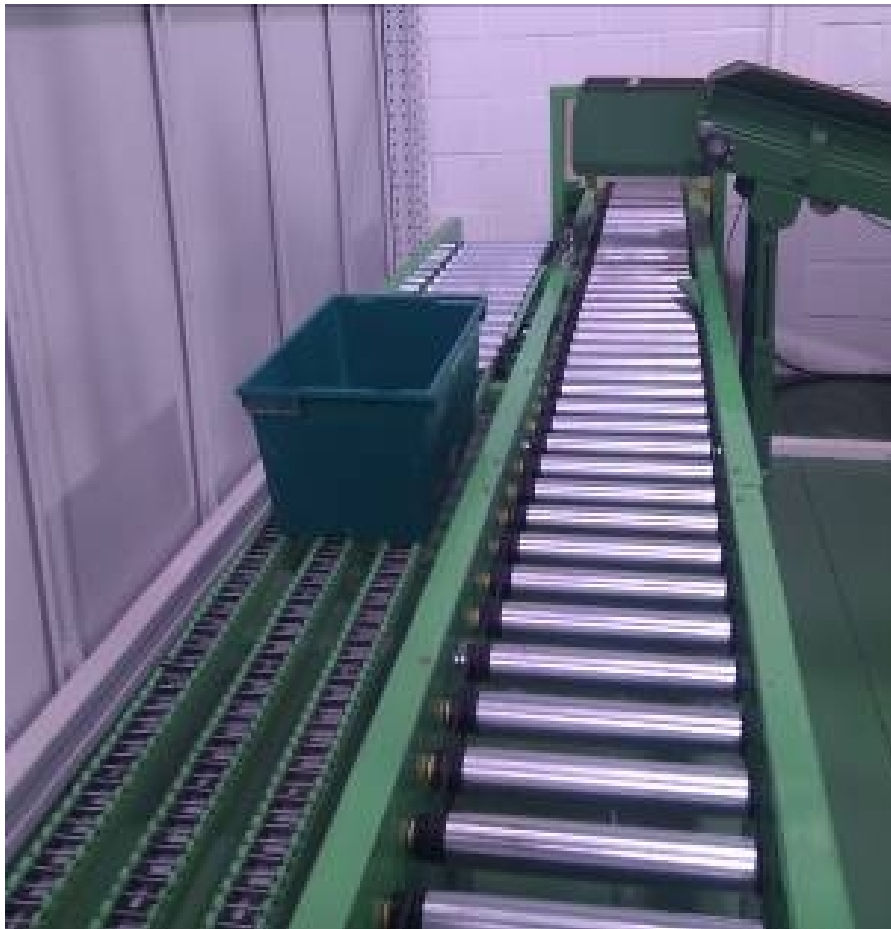
Figura 4.14. Camino de rodillos para movimiento de cubetas hacia cinta de dispensación y desviador para cubetas con errores durante la preparación del pedido.
