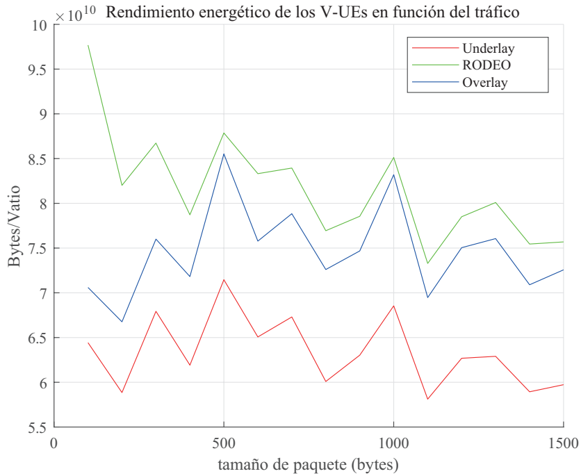
(a) Rendimiento de los V-UEs en función del tipo de tráfico del C-UE
