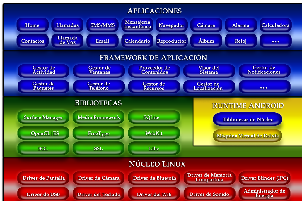
Figura 3.3: Arquitectura del sistema operativo Android
