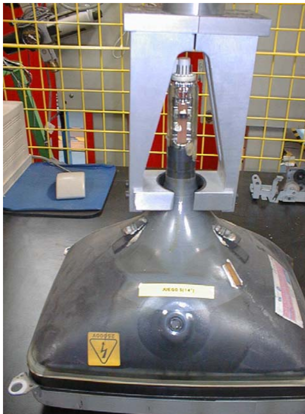
Figura 3.4 Manipulación robotizada del TRC con garra de diseño específico, para manipulador o robot
