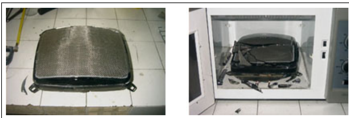
Figura 2.16 Separación de vidrio de pantalla en microondas. Izda.: Empleando mella y malla metálica. Dcha.: Pantalla fracturada en trozos al desprenderse los cantos
