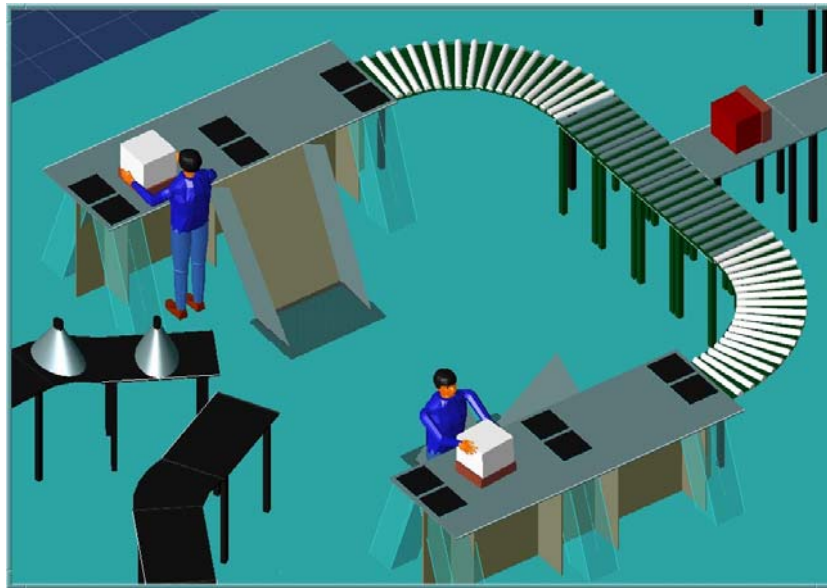
Figura 4.7 Estaciones de desensamblado manual de carcasas y elementos interiores
