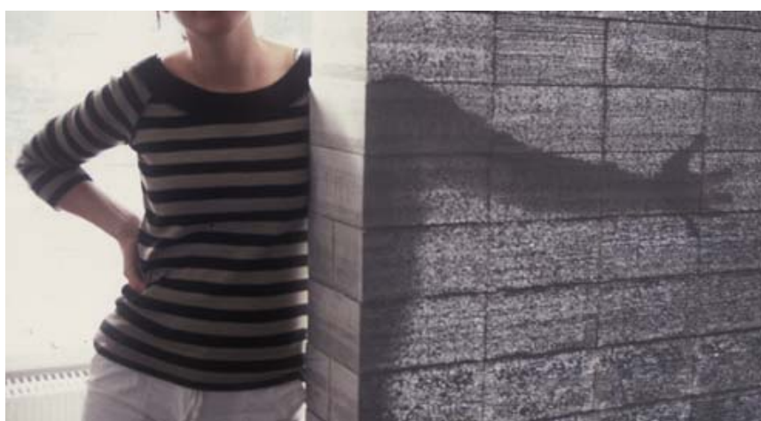
Figura 2.21 El hormigón traslúcido “Litracón”
