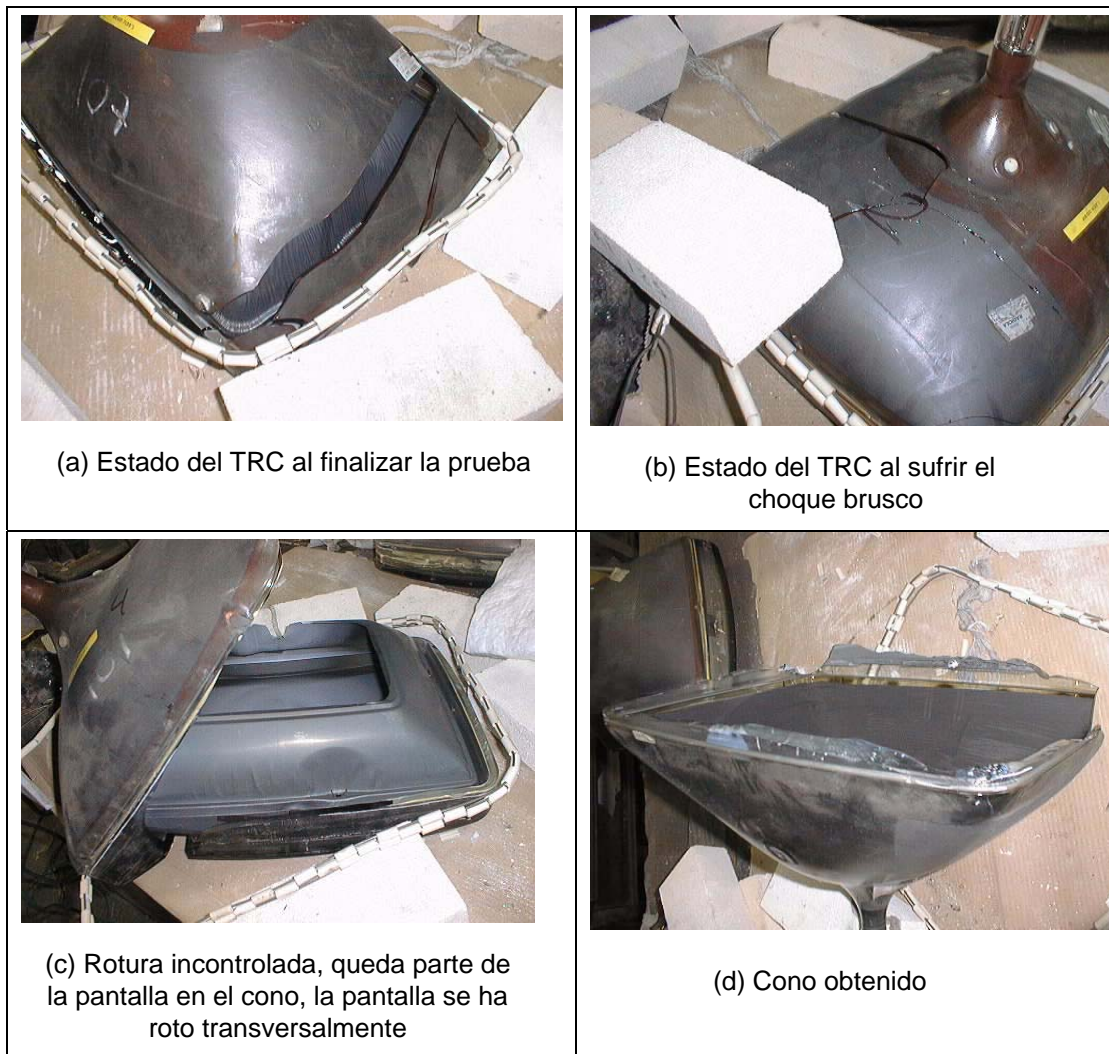
Figura 2.19 Diferentes resultados de la rotura de TRC por choque térmico
