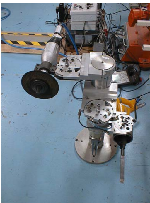
Figura 3.5 Cambios automáticos de herramientas de robot con varios diseños específicos para separación de componentes
