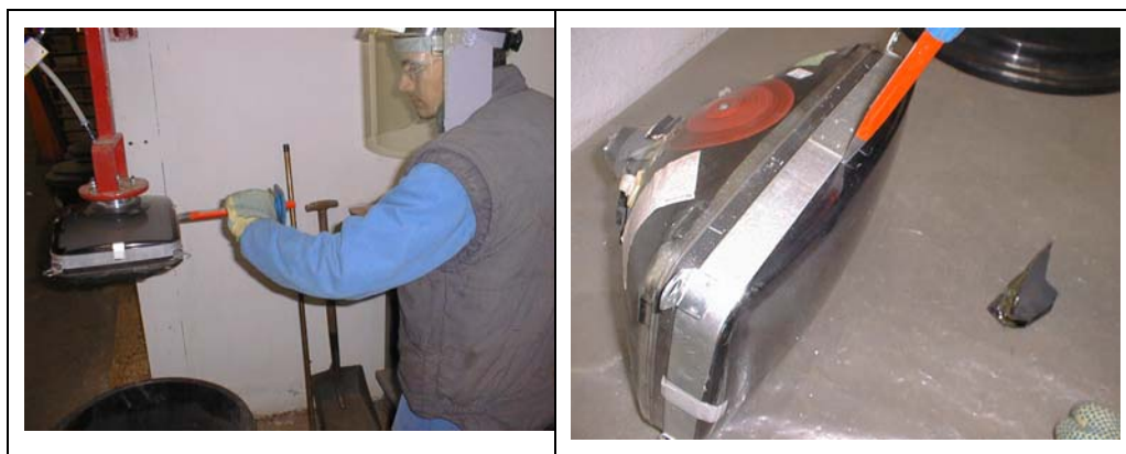
Figura 3.14 Operación manual de separación de vidrios del TRC. Izda: sujeción del TRC por vacío. Dcha: cizalla para separación de vidrios.
