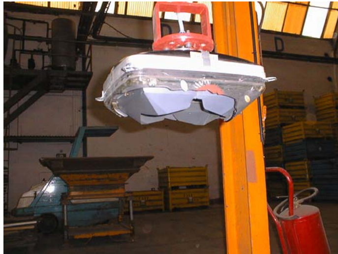
Figura 3.21 Manipulación del TRC con garra de vacío en robot pórtico.
