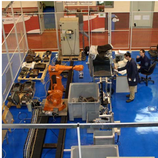
Figura 4.11 Vista general de la célula de desensamblado de TRC y obtención de vidrios
