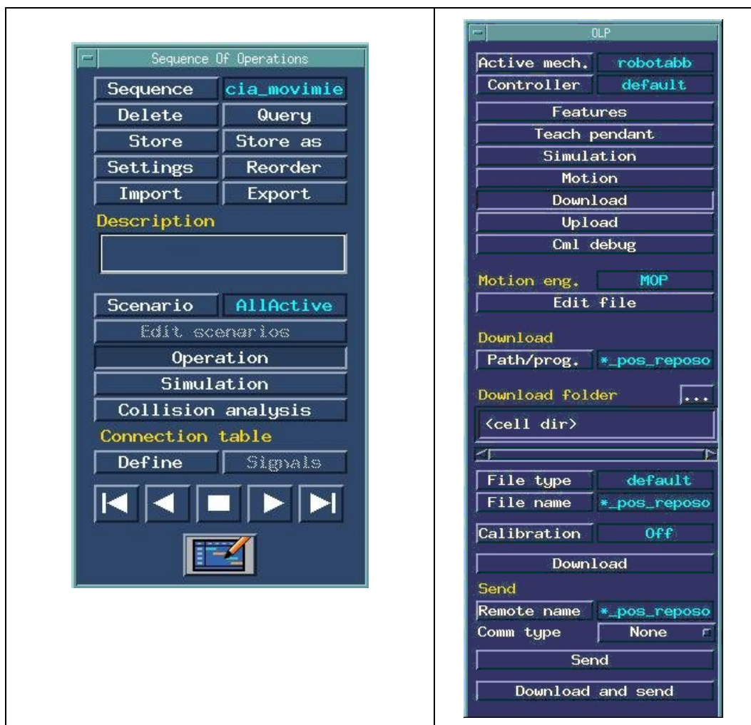
Figura 3.6 Interfaz del sistema de simulación. Izda.: Opciones de programación de operaciones. Dcha.: Generación off-line de programas
