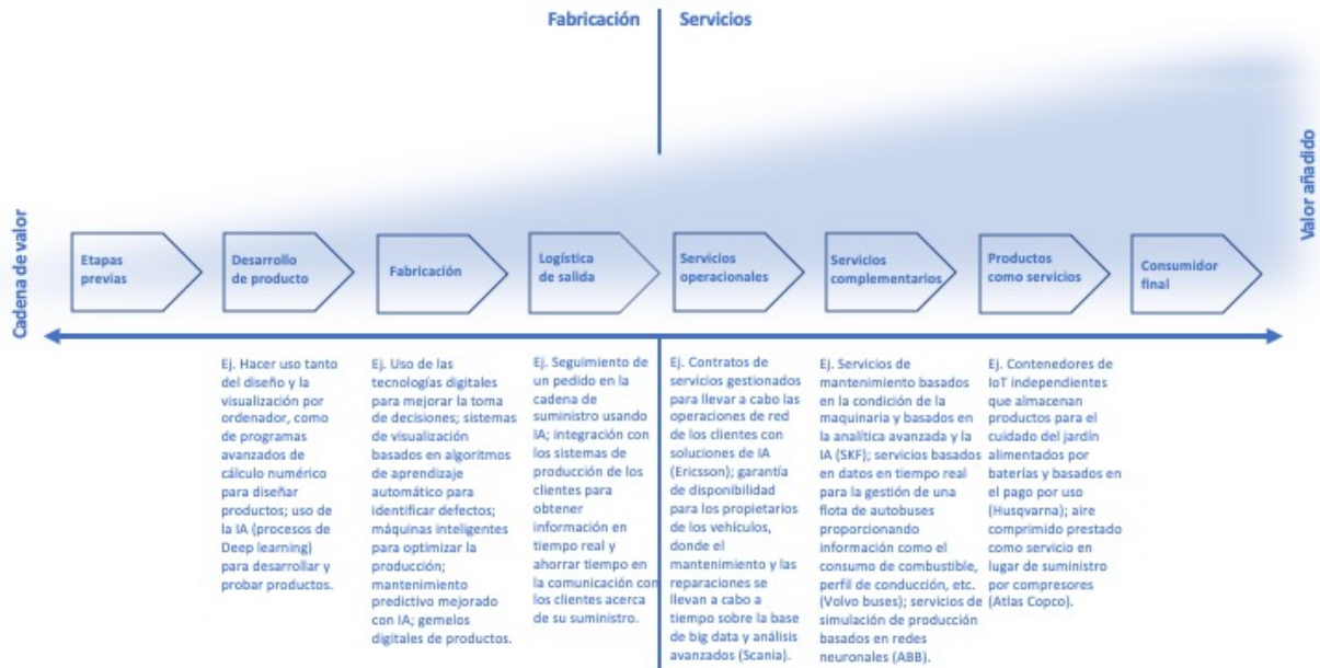
Figura 1.1: Ejemplos de digitalización en relación con las diferentes actividades de la cadena de valor de las empresas de fabricación [6].
