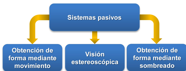
Figura 2.3: Clasificación de los dispositivos de captura 3D pasivos propuesta por Bi y Wang [BW10].
