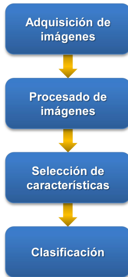
Figura 2.5: Fases de un sistema de visión artificial propuestas por Malamas et ál. [MPZ + 03].
