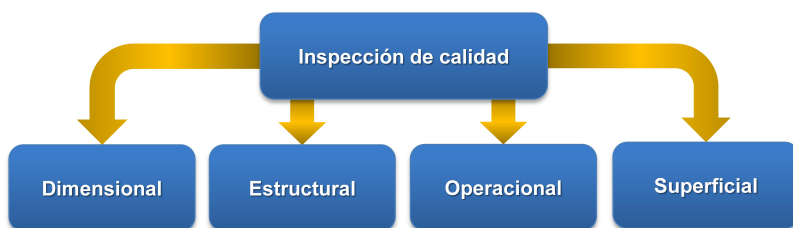
Figura 2.6: Clasificación de aplicaciones de inspección de calidad propuesta por Malamas et ál. [MPZ + 03].
